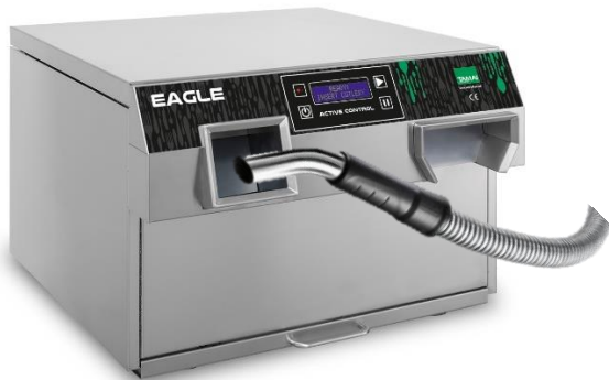
Abbildung 10 – Absaugen des im Tunnel vorhandenen Maisspindelgranulats
